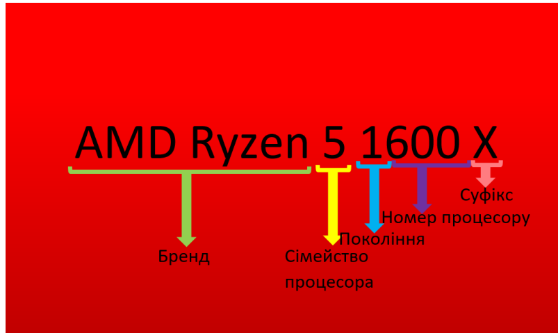
Рисунок 1.10 – Розшифрування назви процесору AMD
