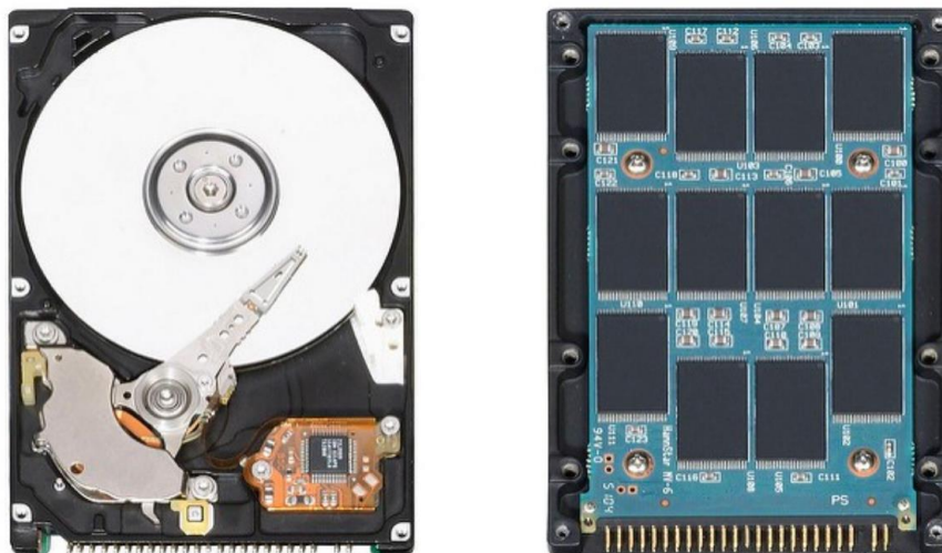
Рисунок 1.12 – Вигляд накопичувачів постійної пам'яті - HDD(зліва) та SSD(справа)
