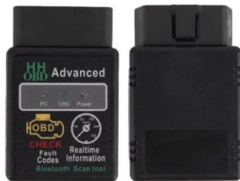
Рисунок 6 Сканер для діагностики автомобіля OBD ELM327 BT
