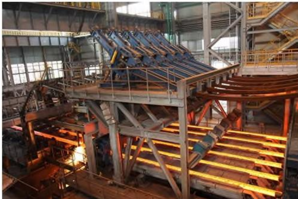
Рисунок 1.2 – Розливка сталі на МБЛЗ конвертерного цеху в умовах ПАТ «АрселорМіттал Кривий Ріг»
