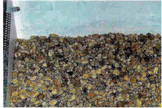
Малюнок 8 Щокова дробарка та отримуваний на ній продукт - вторинний щебінь фракції 20-40 мм
