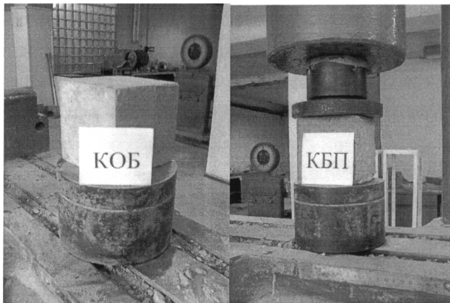
Рис. 10.1 – Загальний вигляд зразків кубів для визначення фізико-механічних властивостей бетонів.
