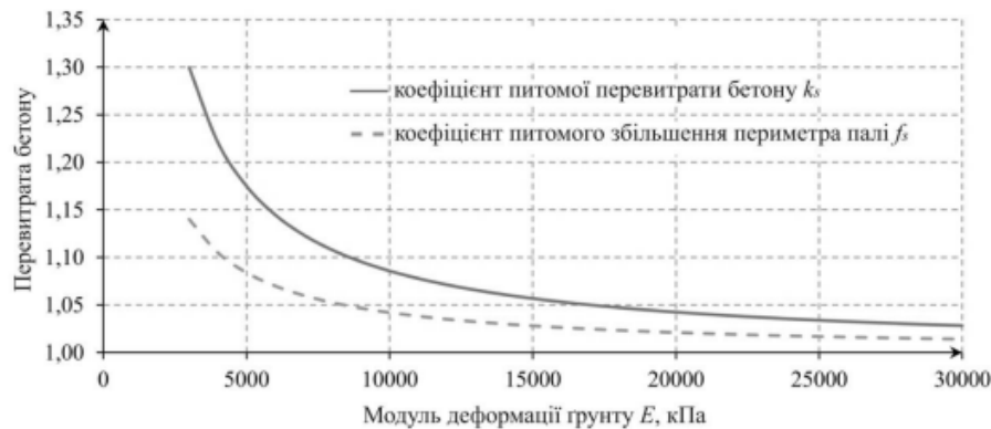
Рис. 7. Графік розподілу коефіцієнтів перевитрати бетону та коефіцієнта питомого збільшення периметра палі залежно від модуля деформації ґрунту
