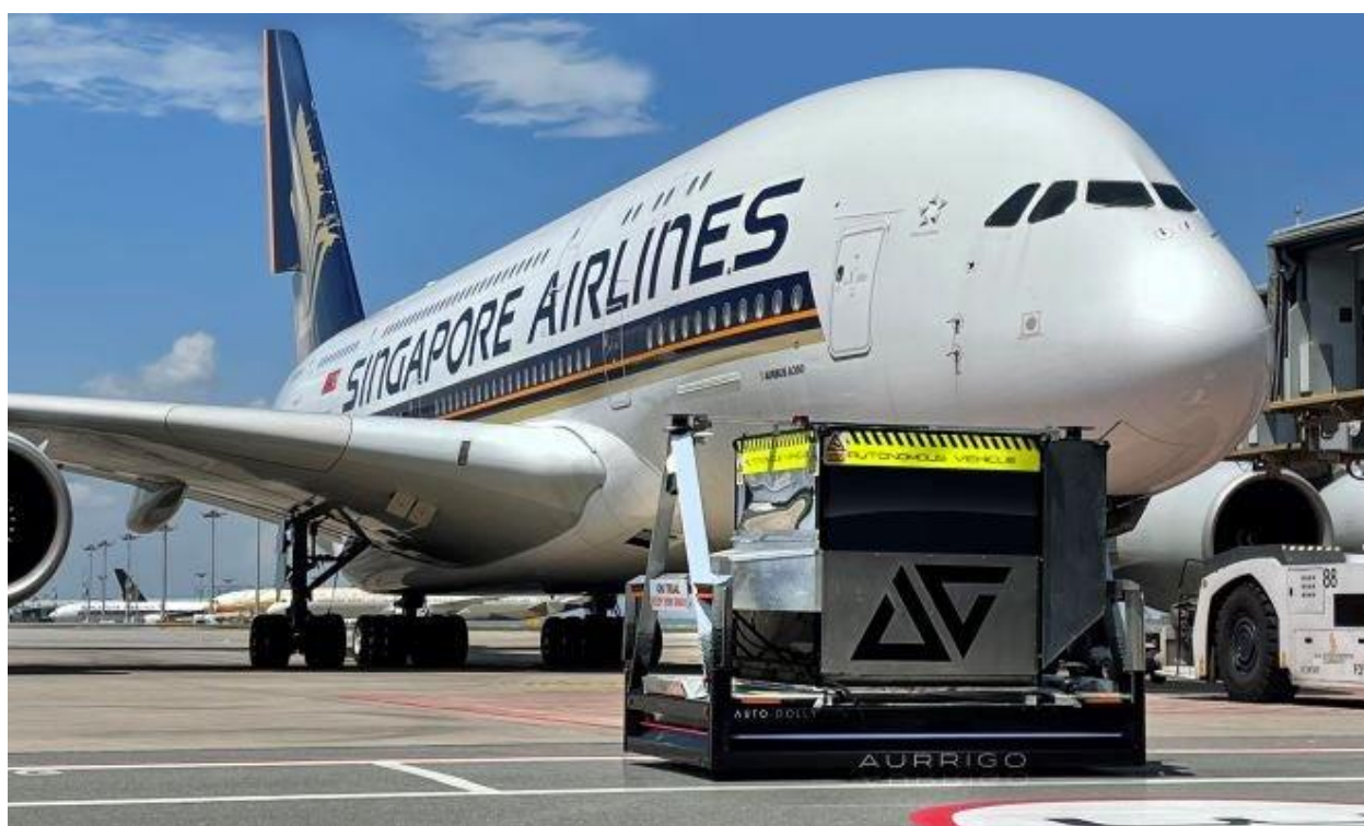
Рисунок 1.3 – Автономне завантаження літаків компанії Aurrigo
