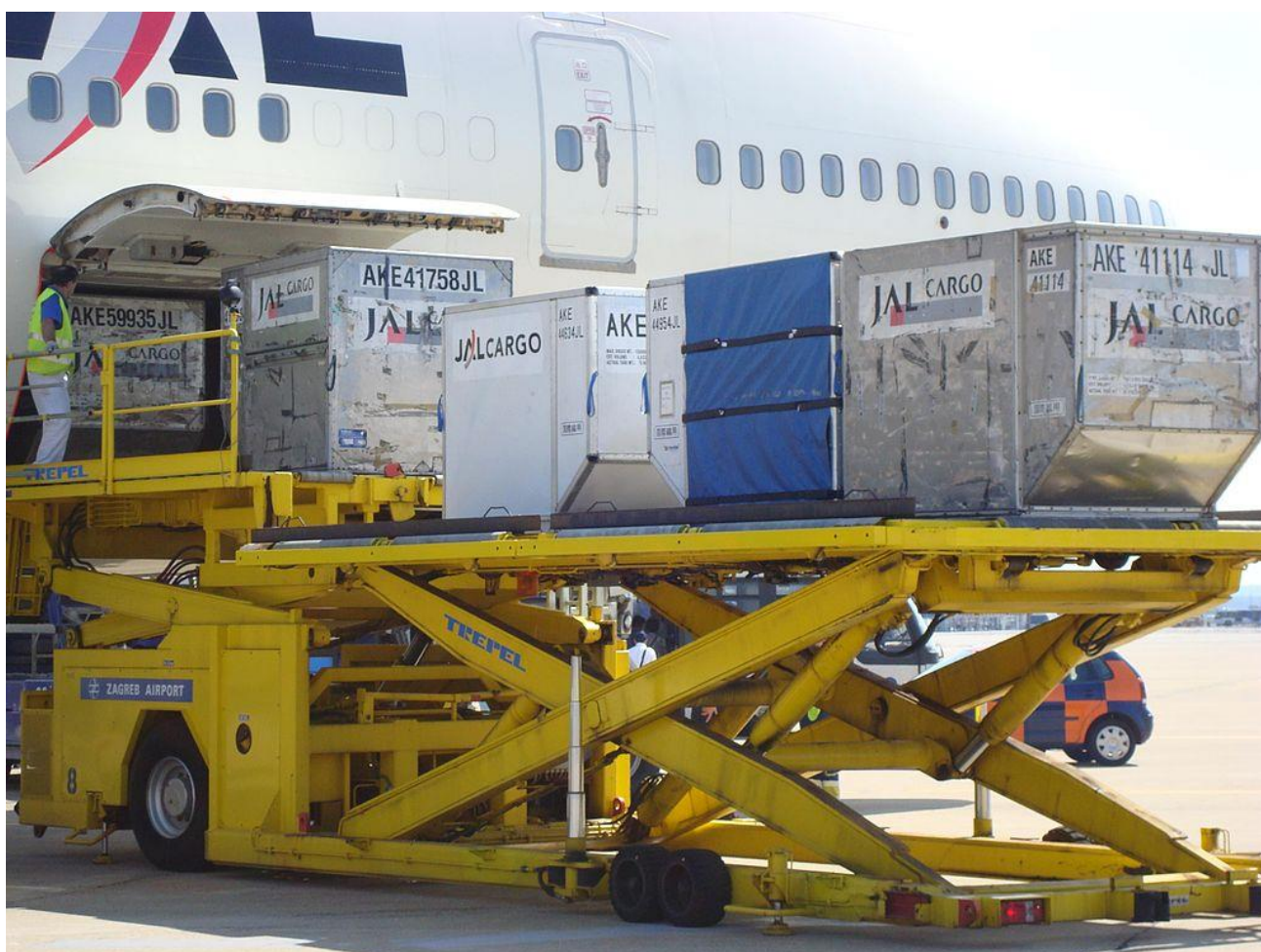
Рисунок 1.1 – Авіаційний засіб пакування (ULD)
