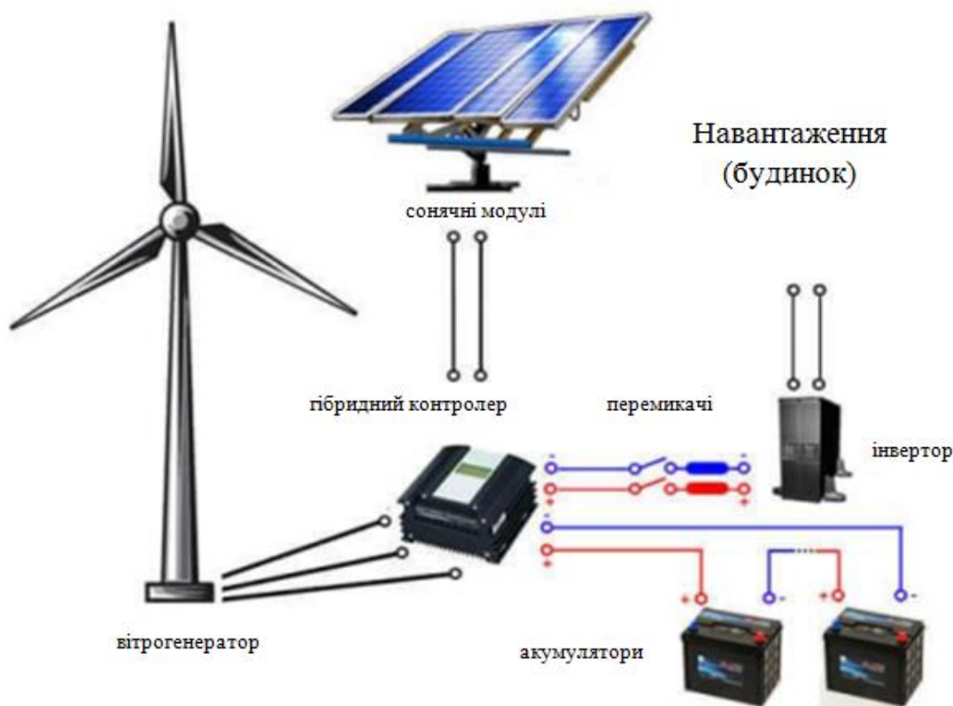
Рис.2.8 Схема гібридної вітро-сонячної електростанції
