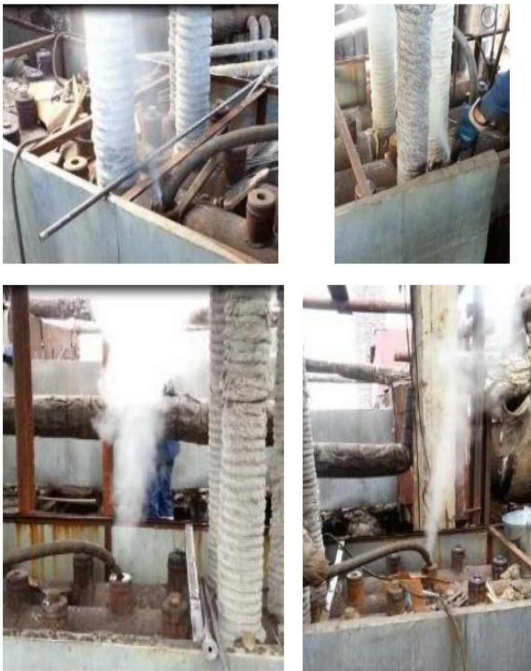
Рис.4.1 Неконтрольовані втрати теплоносія під час заповнення термосифонів.
