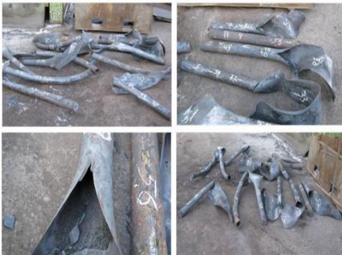
Рис. 1.6 Загальний вигляд термосифонів, що вийшли з ладу
