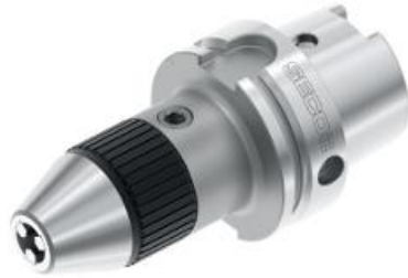
Рисунок 3.44 – Свердлильний патрон E9306508532 [16, с.107] Геометричні параметри: OAL = 368 мм; LPR = 268 мм; LB = 210 мм; BD1 = 112 мм; DCBN-DCBX = 5-32 мм.
