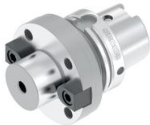
Рисунок 3.47 – Державка HSKA100-SMF60-075 [16, с.76] Геометричні параметри: DMM = 60 мм; LF = 75 мм; BD = 129 мм; OAL = 165 мм; LSC = 40 мм; DBC = 101,6 мм; TDZ = M16
