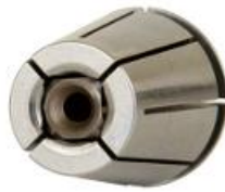
Рисунок 3.45 – Цанга 393.14-25D060X049 [16, с.329] Геометричні параметри: LB = 18 мм; BD1 = 25,8 мм; KWW = 4,9 мм; OAL = 34 мм; DCBN-DCBX = 6 мм
