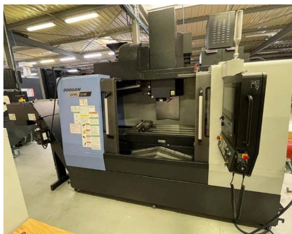
Рисунок 3.6 - Свердлильно-фрезерно-розточний верстат DOOSAN DNM 5700 та його технічні характеристики [9]
