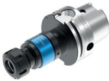
Рисунок 3.46 – Метчиковий патрон E9304586725128 [16, с.108] Геометричні параметри: LPR = 122,5 мм; LB = 96,5 мм; LB1 = 37,1 мм; BD = 44 мм; BD1 = 42 мм; OAL = 154,4 мм; SW = 28 мм
