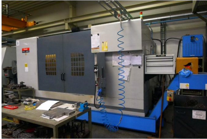
Рисунок 3.7 - Вертикальний багатопільовий верстат Mazak VTC-200C та його технічні характеристики [10]
