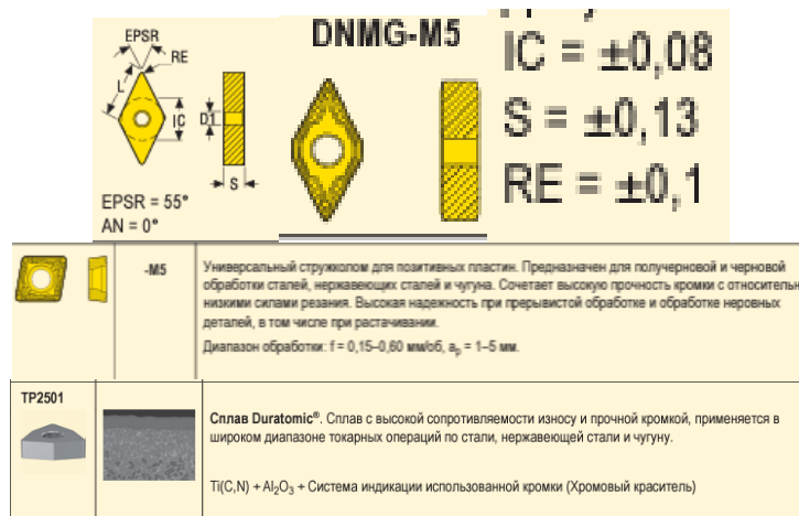
Рисунок 3.15 – Пластина DNMG150608-M5 [11, с.438], CVD – покрытие TP2501 [11, с.50]
