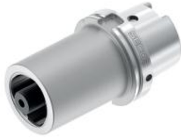
Рисунок 3.43 – Тримач С5-390.410-63090С [16, с.116] Геометричні параметри: LF = 90 мм; LB = 64 мм; BD = 50 мм; OAL = 122 мм
