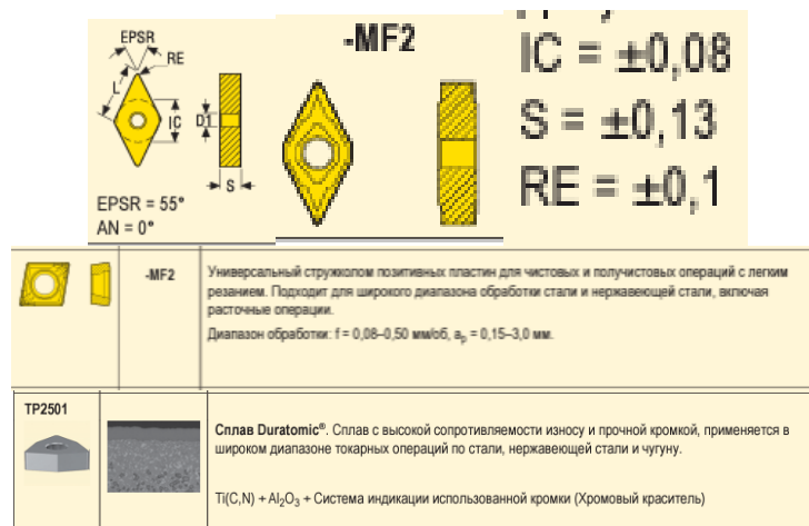
Рисунок 3.19 – Пластина DNMG150608-MF2 [11, с.436], CVD – покриття TP2501 [11, с.50]
