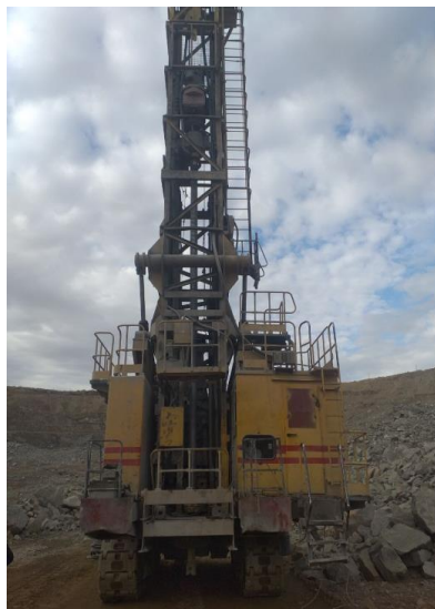
Рисунок 7.1- Бурова установка СБШ-250МНА-32
