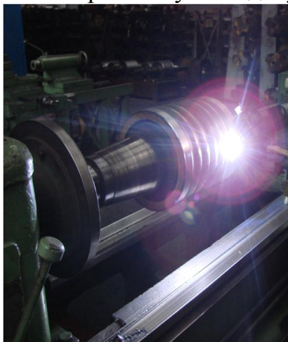
Рисунок 9.5-Процес мікроплазмового зміцнення
