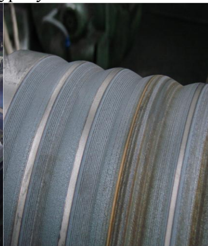
Рисунок 9.7- Види мікроплазмового зміцнення 1-оксамитове, 2-без оплавлення, 3- з оплавленням
