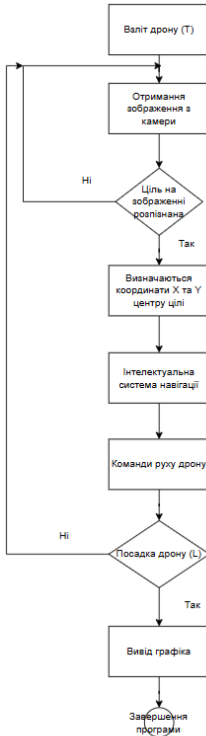
Рисунок 3.5 - Загальна блок схема алгоритму системи
