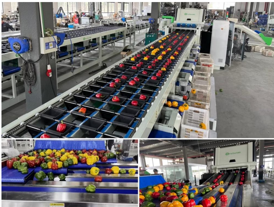
Рисунок 1.2 – Система сортування продуктів кольоровими камерами
