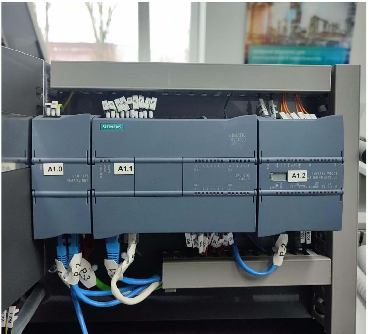
Рисунок 1.2 – Мікроконтролер S7-1200 та модулі Simatic CSM1277 для налаштування зв'язку та WP231 вагового модуля
