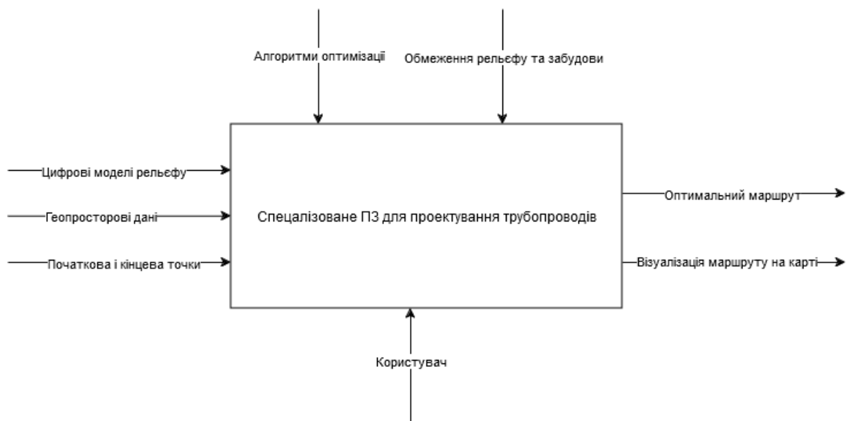
Рисунок 2.1 – Функціональна схема програмного забезпечення ????????
