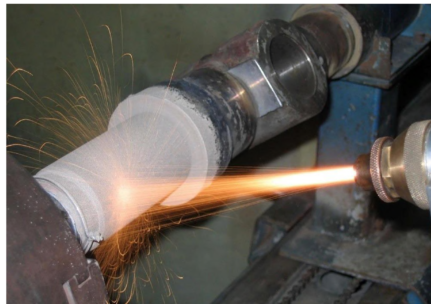
Процес газотермічного напилювання
