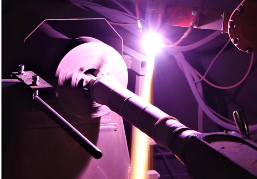
Рисунок 7.5 – Процес плазмового напилювання
