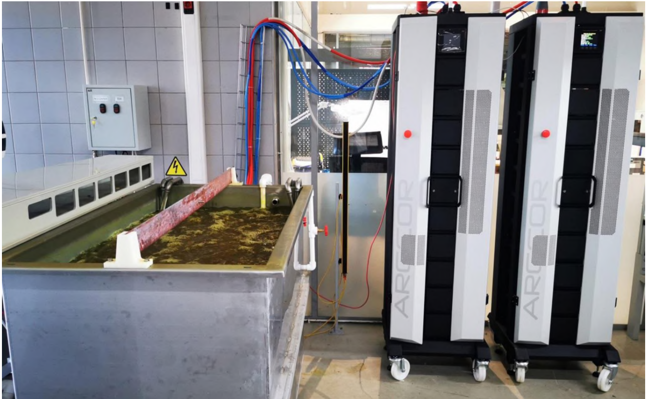
Рисунок 7.6 – Обладнання для реалізації мікродугового оксидування
