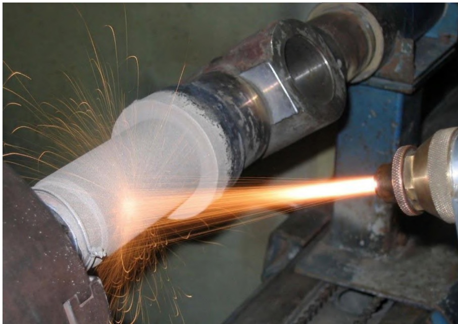
Рисунок 7.11 – Процес газотермічного напилювання
