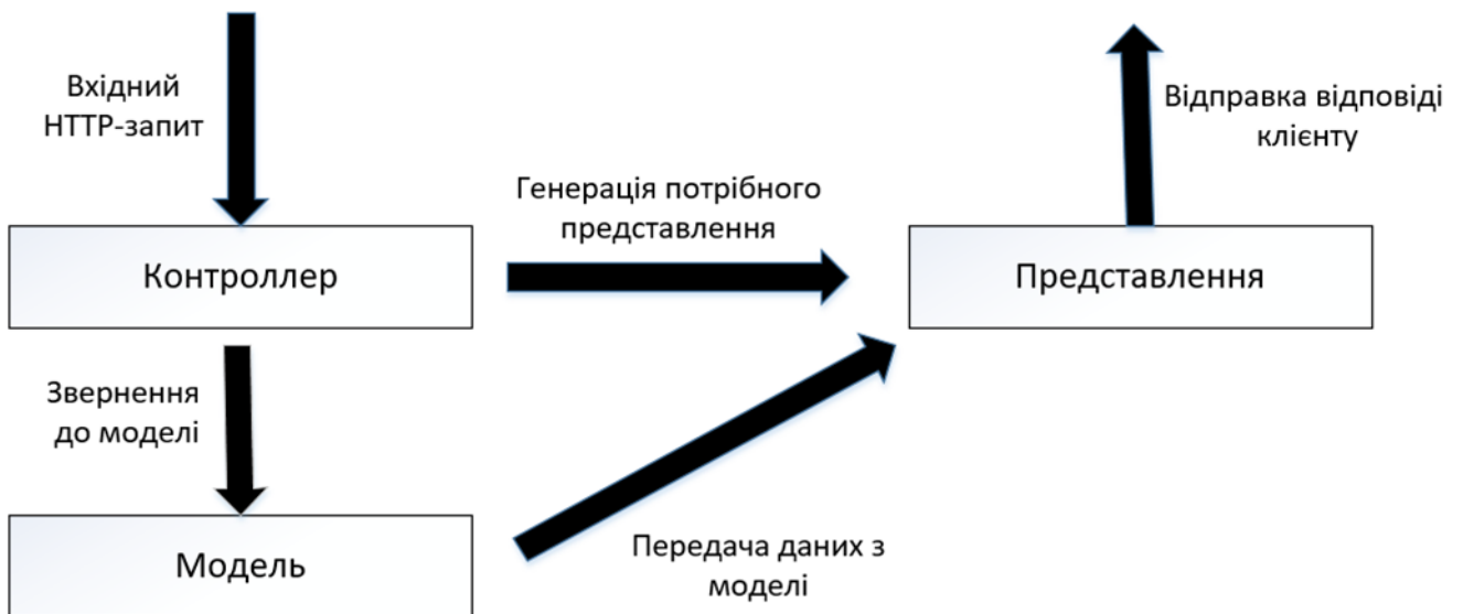
Рисунок 3.1 – Структура функціонування ASP.NET Core
