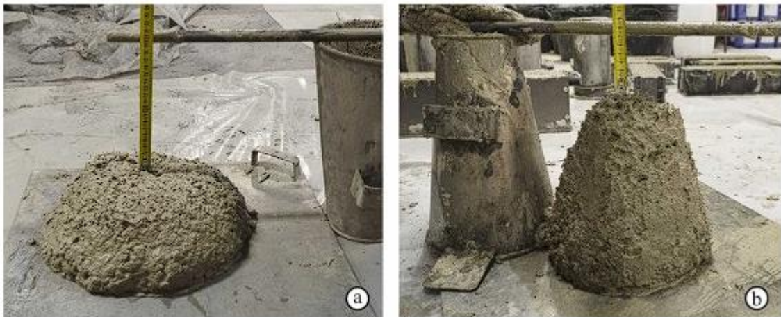
Рис. 6 . Випробування на осадку бетонних сумішей 0R1 (a) і (b).
