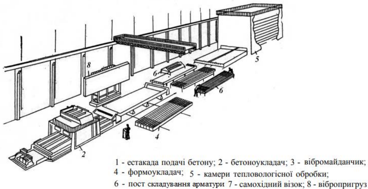
Рисунок 7. Компоновка формувальної лінії:
