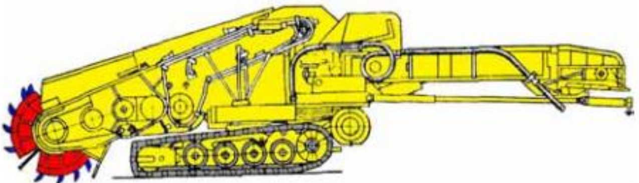
Рисунок 1.7 – Схема малогабаритного шнекового комбайну КМШ розробки інституту ВНДШрудмаш
