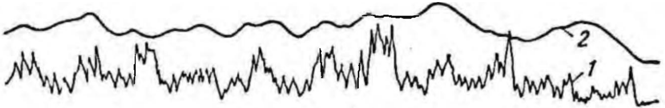
Рис 1.10 – Осцилограма зміни зусиль різання при виїмці суглінка роторним ескаватором Р-60: 1 - колового; 2 – бічного [11,12]
