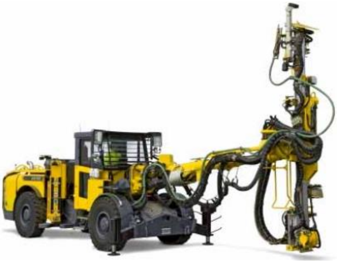
Рисунок 1.3 – Установка для зведення болтового анкерного кріплення Voltec LC шведської фірми «Atlas Copco»
