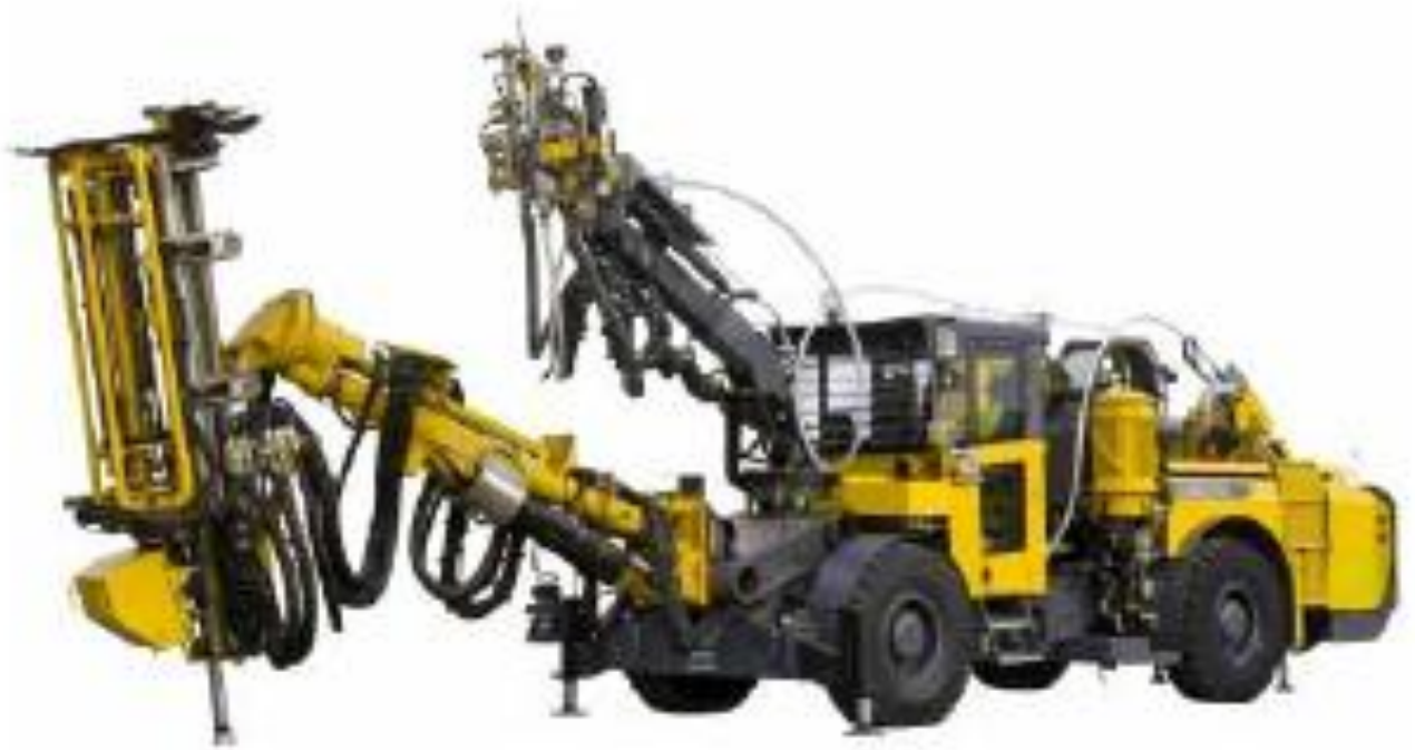
Рисунок 1.4 – Установа для зведення тросового анкерного кріплення Cabletec LC шведської фірми «Atlas Copco»
