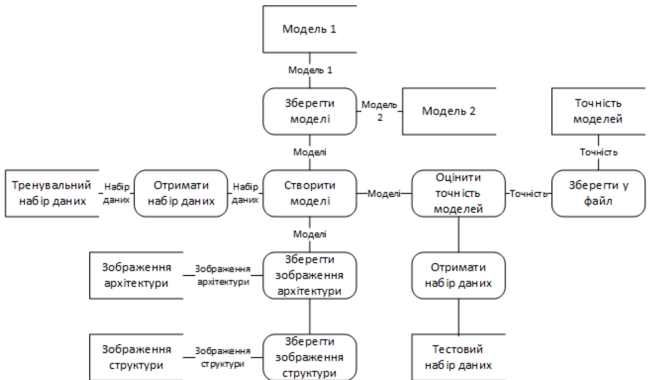
Рисунок 2.16 – Діаграма потоків даних у процесі створення моделей штучних нейронних мереж
