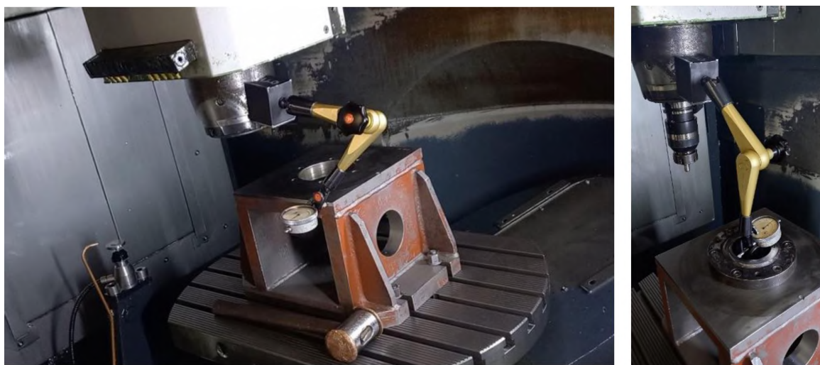
Рисунок 4.27– Виставлення по площинах осей «X Y Z B» та во осі «C»
