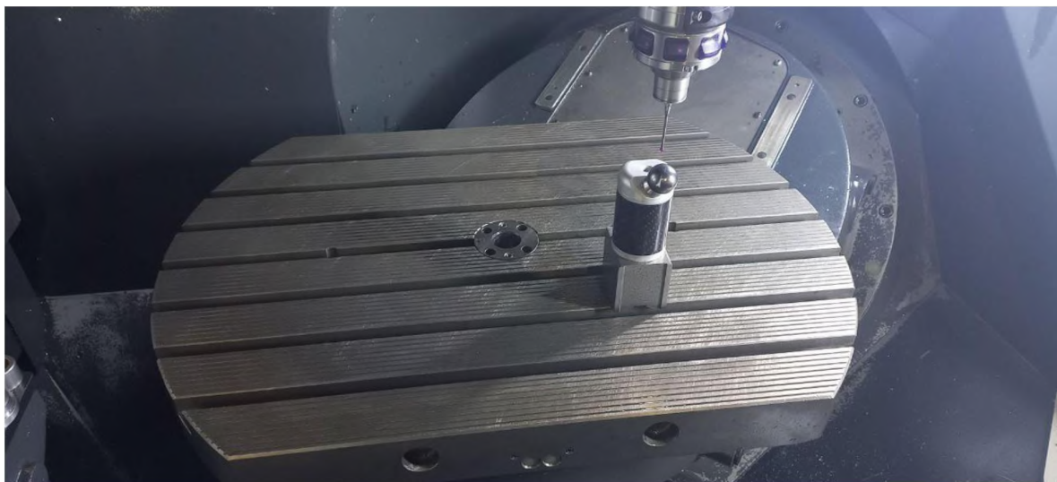
Рисунок 4.24 – Каліброва верстату «3D quickSET»
