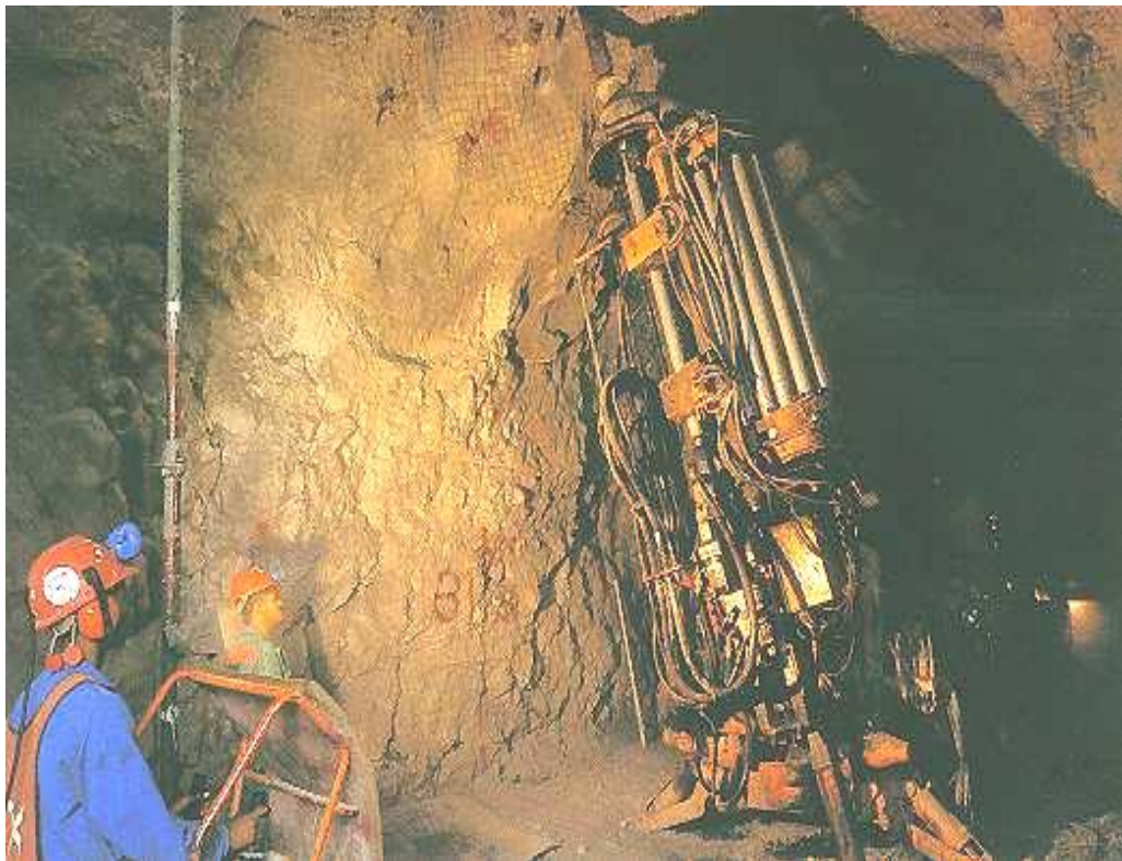
Рис. 5. Застосування напівавтоматичного бурового устаткування "Tamrock" на шахті «Фінч»
