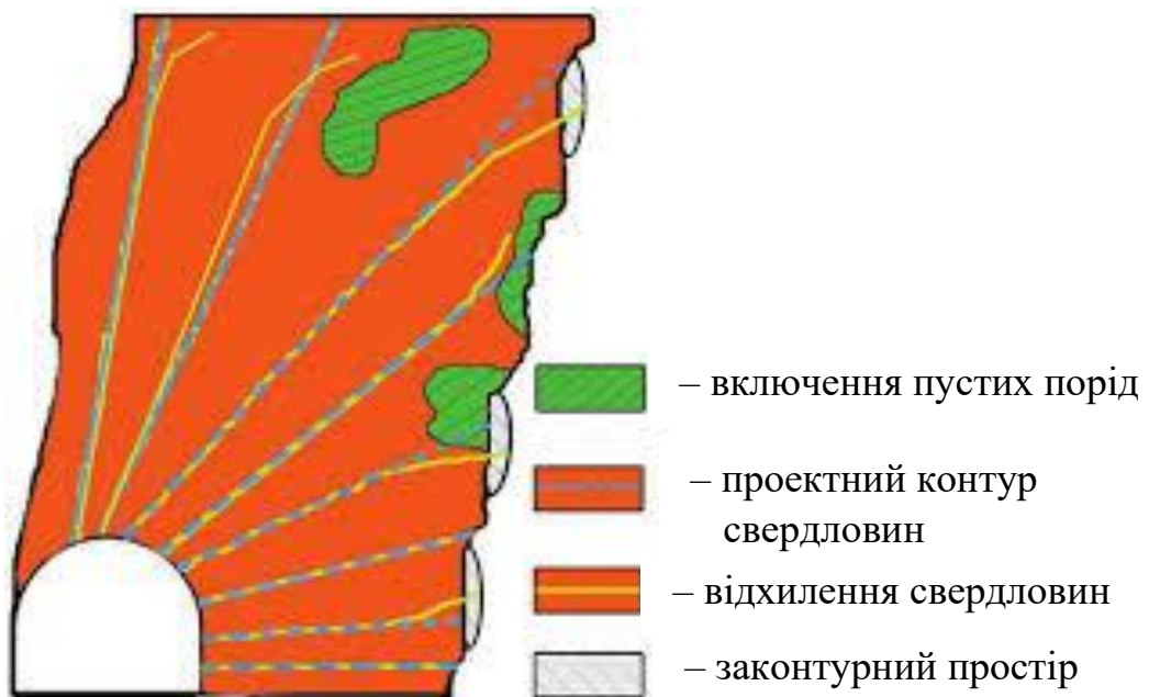
Рис. 10. Варіанти можливого відхилення напрямку глибоких свердловин при розбурюванні масиву блоку
