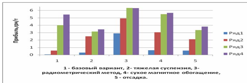
Рис. 2. Зависимость прибыли, получаемой при обогащении окисленной железной руды при применении различных методов обогащения на шахтах Кривбасса: ряд 1 - данные шахты им. Ленина; ряд 2 - шахта Гвардейская; ряд 3 - шахта Родина; ряд 4 - шахта Октябрьская
