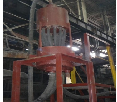
б подача живлення на грохот із пульрозподілювач
