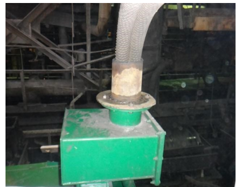
б подача живлення на грохот із пульрозподілювач
