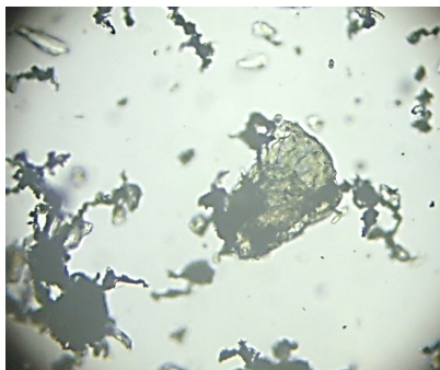
Рис. 2.7. Мінеральний склад пінного продукту РЗФ-2 ПРАТ ІНГЗК (петрографічний мікроскоп, імерсійний препарат. Збільшення: а, б, г – 330 X; в – 200 X; д – 250 X; е – 570 X): а, б – кварц (не забарвлений) з численними включеннями магнетиту (чорне); в – куммінгтоніт (зеленувато-жовтий) у складній флокулі з магнетитом; г – глаукофан (породоутворювальний мінерал класу силікатів); д - уламкове зерно егірину з включеннями магнетиту, що утворюють магнітні флокули з «вільними» дрібними зернами магнетиту; е - актиноліт з пиловидними включеннями магнетиту, ланцюжкові мікрофлокули магнетиту.
