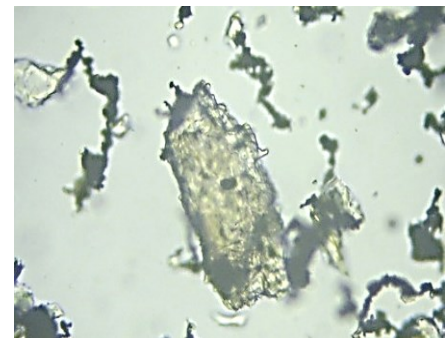
Рис. 2.7. Мінеральний склад пінного продукту РЗФ-2 ПРАТ ІНГЗК (петрографічний мікроскоп, імерсійний препарат. Збільшення: а, б, г – 330 X; в – 200 X; д – 250 X; е – 570 X): а, б – кварц (не забарвлений) з численними включеннями магнетиту (чорне); в – куммінгтоніт (зеленувато-жовтий) у складній флокулі з магнетитом; г – глаукофан (породоутворювальний мінерал класу силікатів); д - уламкове зерно егірину з включеннями магнетиту, що утворюють магнітні флокули з «вільними» дрібними зернами магнетиту; е - актиноліт з пиловидними включеннями магнетиту, ланцюжкові мікрофлокули магнетиту.
