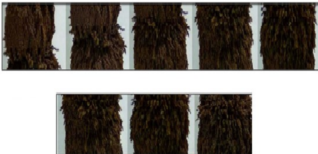
Рис.3.2. Форма і структура осаду тонкоподрібненої магнетитової суспензії при його видаленні з його поверхні магнітної системи барабану
