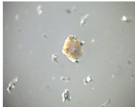
Рис. 2.11. Мінеральний склад камерного продукту флотації (петрографічний мікроскоп, імерсійний препарат. Збільшення - 400 x ): а – ідіоморфний кристал і магнітні флокули магнетиту (чорне); б – зростки магнетиту з кумінгтонітом (світло-сіре); в – магнетит у вигляді відокремлених кутастих зерен, магнітних флокул і дрібних включень у кварці (не забарвлене); г – кварц з включеннями гетиту (буре) і гідрогематиту (червоне).
