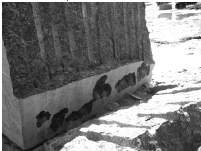
Рис. 1. Результат неконтрольованої швидкості розповсюдження магістральної тріщини
