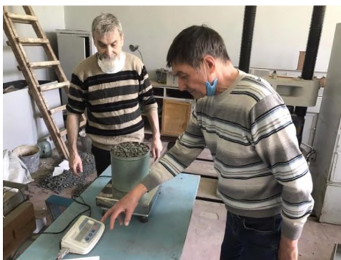
Рис.3. Зважування вимірювального циліндру зі щебенем на настільних електричних вагах
