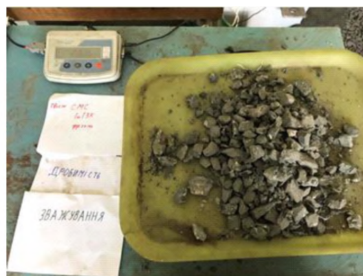
Рис. 6. Зважування наважки щебіня з хвостів СМС ІнгЗК після дроблення
