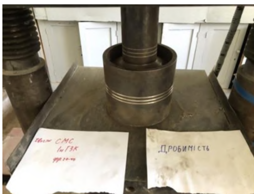
Рис. 5. Наважка щебіня з хвостів СМС ІнгЗК після навантаження
