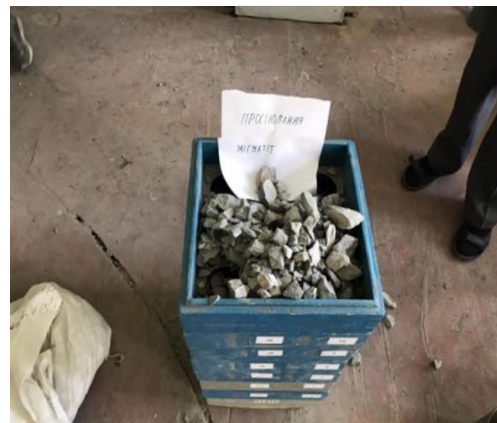
Рис. 2. Просіювання навішування класу 0-70 мм на стандартному наборі сит
