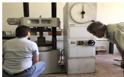
Рис. 4. Встановлення циліндру з наважкою щебіня з хвостів СМС під прес
