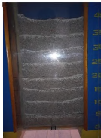
Рис. 2. Тестове засипання сухого матеріалу на визначену висоту
