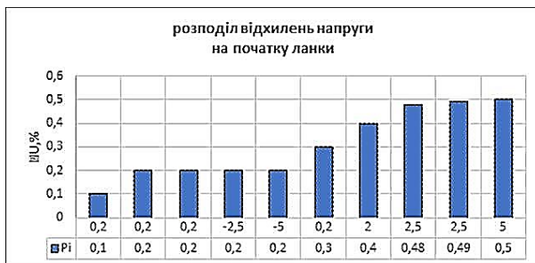
Рис. 1. Розподіл відхилень напруги підстанції «Північна», гор. – 1390 ш. «Казацька», (зрушення діапазону – 3,75%). Початок ланки
