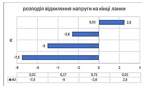
Рис. 2. Розподіл відхилень напруги підстанції «Північна», гор. –1390 ш. «Казацька», (зрушення діапазону – 3,75%). На кінці ланки
