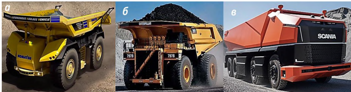
Рис. 3. Автономні безпілотні роботизовані автосамоскиди: а – «Komatsu», б – «Caterpillar», в – «Scania»
