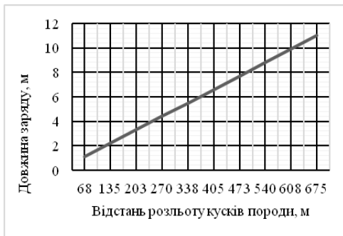
Рис. 3. Графік для визначення відстаней розльоту кусків гірської породи від довжини заряду в свердловині l_2 для: a - f=14, a = (6 \times 6) м; б - f=7, a = (7 \times 7) м
