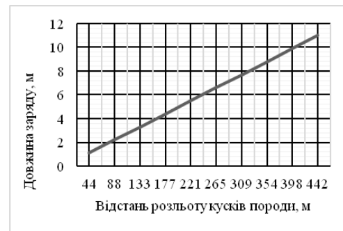
Рис. 3. Графік для визначення відстаней розльоту кусків гірської породи від довжини заряду в свердловині l_2 для: a - f=14, a = (6 \times 6) м; б - f=7, a = (7 \times 7) м
