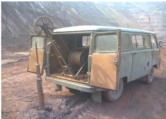
Рис. 5. Загальний вид каротажної станції «Кар'єр-Кривбас» в умовах кар'єру
