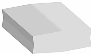
Рис. 3. Форма розкату після проходу ребрової кліті (а) та калібрування гладких валків (б)
