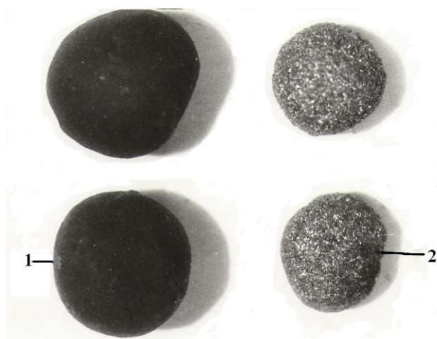
Рис. 5.18. – Вихідні вуглемасляні гранули-носії (1) та ці ж гранули з налиплими золотовмісними часточками після адгезійної сепарації.
