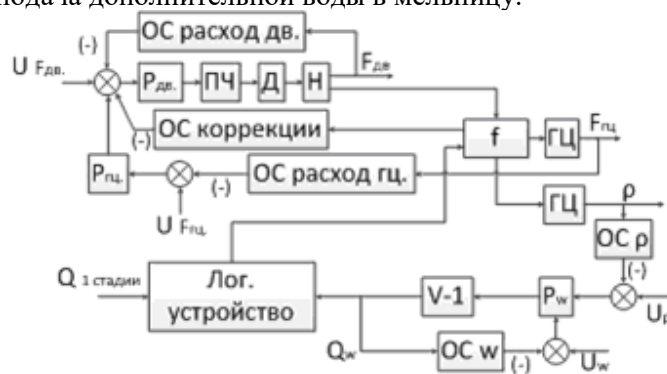
Рис. 3. Алгоритмічна структурна схема системи управління при детермінованих параметрах
