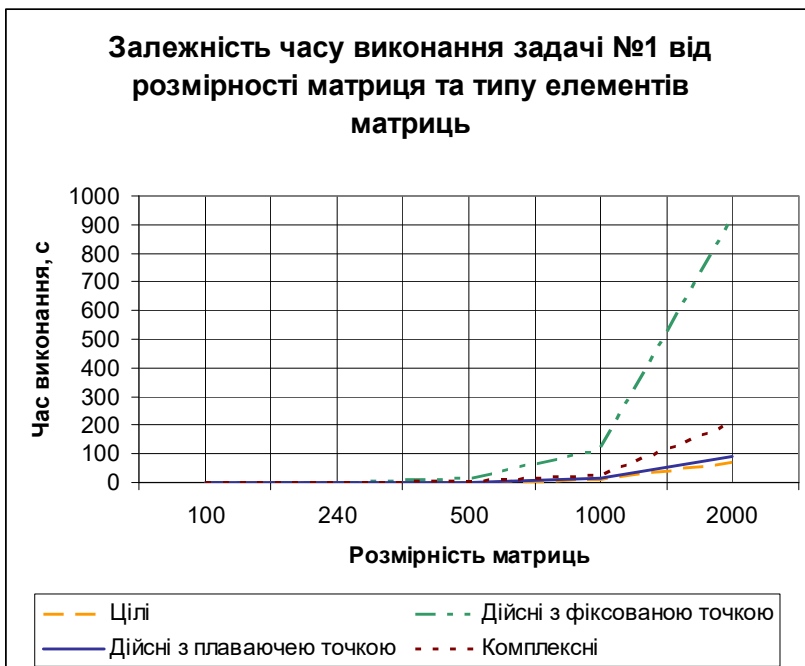
Рис. 2 - Графік залежності часу виконання задачі від розмірності матриць та типу елементів
