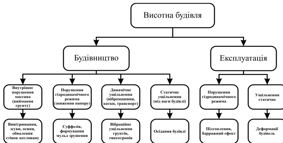
Рис. 2. Схема взаємодії системи «основа – фундамент – висотна будівля»
