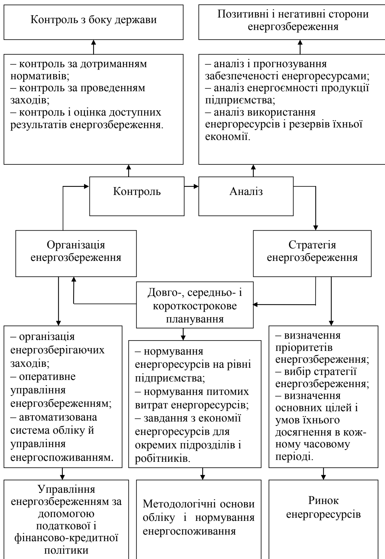
Рис. 8. Схема процесу управління енергозбереженням на підприємстві
