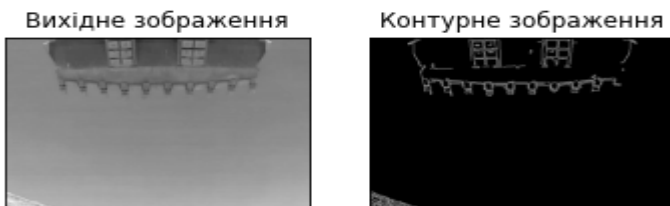
Рис.1 Виявлення контурів зубів ковша кар'єрного екскаватору
