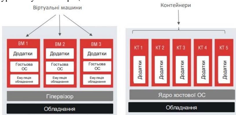
Рис. 1. Схеми роботи віртуальних машин та контейнерів
