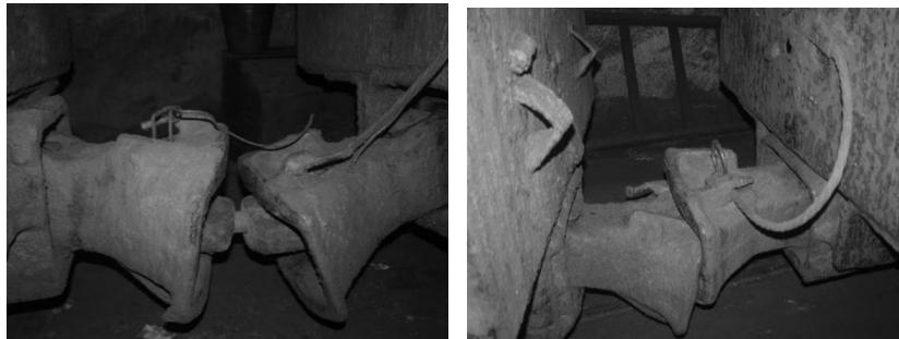
Рис. 2. Иллюстративное фото крайних положений сцепного устройства электровазосостава с вагонетками
