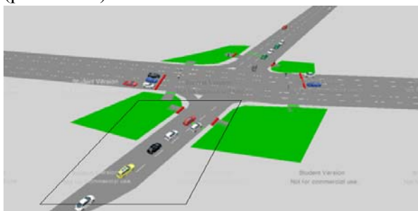
Рис. 9. Розширення проїзної частини по вул. Гетьманська
