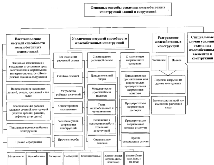
Классификация способов усиления железобетонных конструкций
