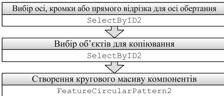
Рис. 10.5. Послідовність створення кругового масиву компонентів
