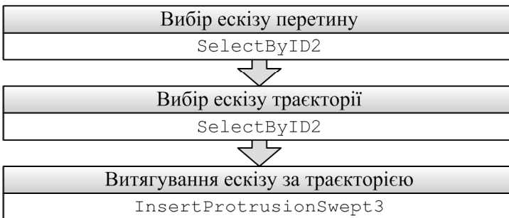
Рис. 8.3. Послідовність витягування ескізу за траекторією
