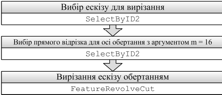
Рис. 8.6. Послідовність створення вирізу обертанням
