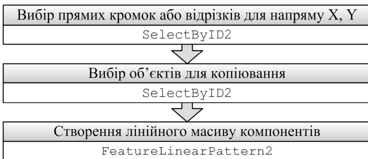
Рис. 10.4. Послідовність створення лінійного масиву компонентів
