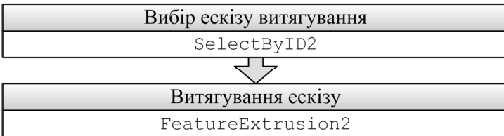
Рис. 8.1. Послідовність використання інструменту Вытянутая бобышка
