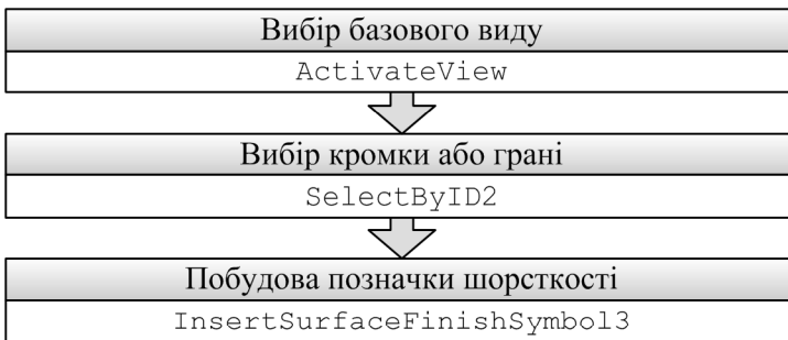
Рис. 9.8. Послідовність створення позначки шорсткості
