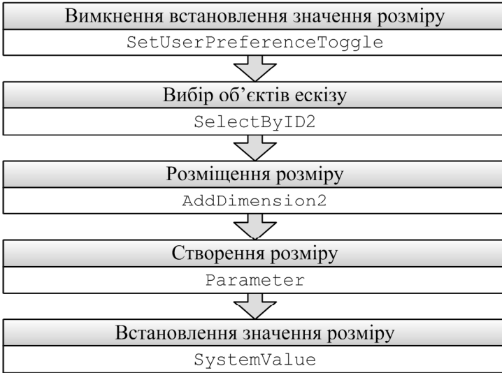
Рис. 7.19. Послідовність встановлення розміру
