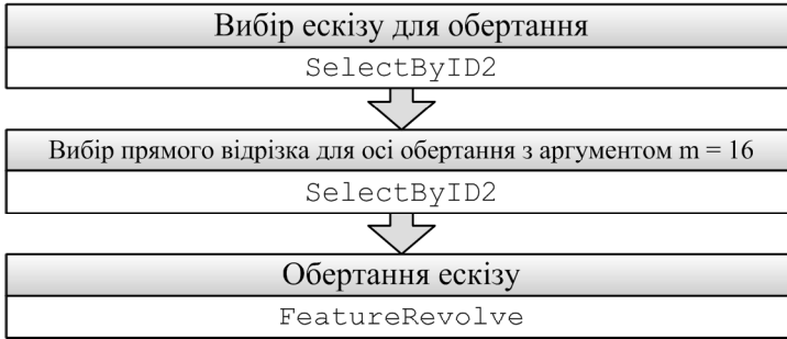
Рис. 8.2. Послідовність використання інструменту Повёрнутая бобышка
