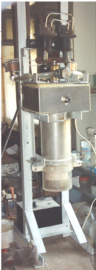
Рис. 4.1. Стенд для вивчення впливу конструкції коронки на процес винесення шламу: 1 – труба зовнішня; 2 – труба внутрішня; 3 – патрубок; 4 – склянка; 5 – затиски пружинні; 6 – приймальний бункер; 7 – пластина сполучна; 8 – макет корпусу; 9 – кільце з пазами; 10 – електричні клапани; 11 – шланги; 12 – трійник; 13 – електромагніт; 14 – тяга; 15 – рама; 16 – втулка напрямна
