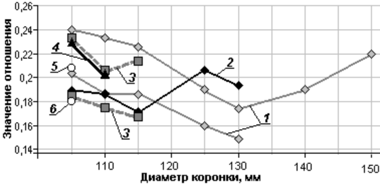
Рис.1. Отношение суммарной площади штырьков у площади забоя: 1 – FlatFace; 2 – Convex; 3 – Groove; 4 – DropCenter; 5 – Concave; 6 – КНШ-105
