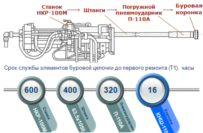
Рис. 1. Пример буровой цепочки и сроки службы основных её элементов
