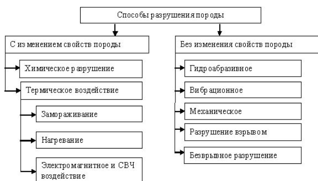
Рис 3. Способы разрушения пород
