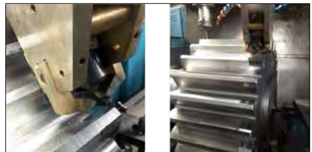
Рис. 3. Процес обробки вал-шестірні методом ППЗ в умовах виробництва
